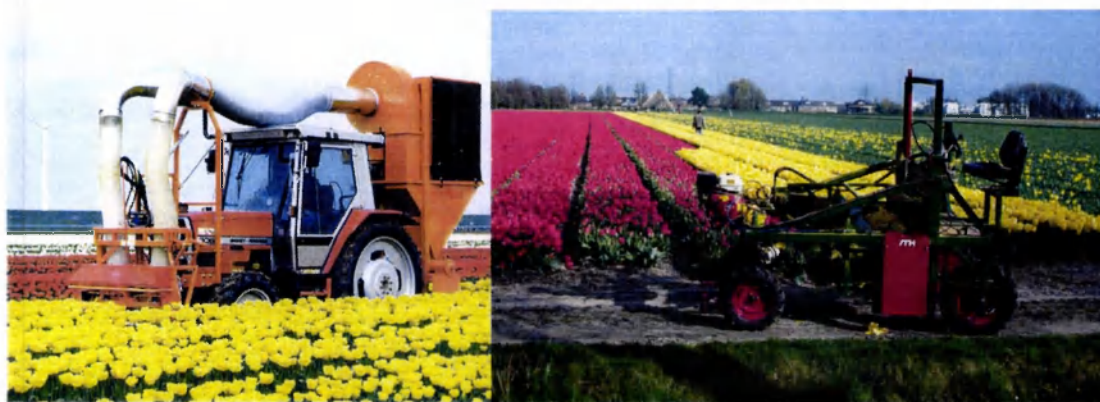
Figuur 4.9 Kopmachine met afzuiging en een gemotoriseerde kopmachientje
