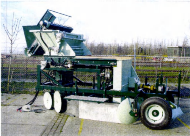
Figuur 4.6 Lelieplantmachine met schip (Van Hienen)
