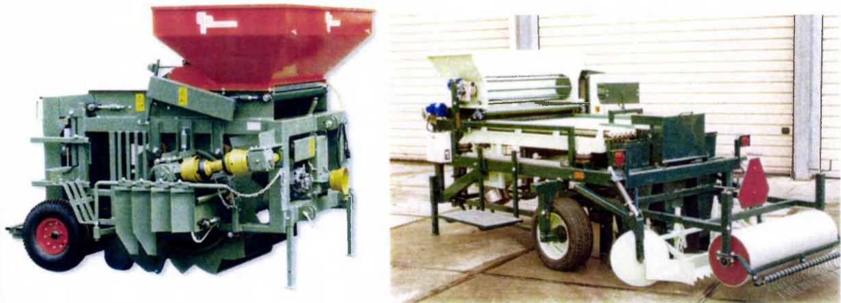
Figuur 4.5 Overschietmachine (Kos mechanisatie) en een plantmachine met rollenzeef (Van Hienen)
