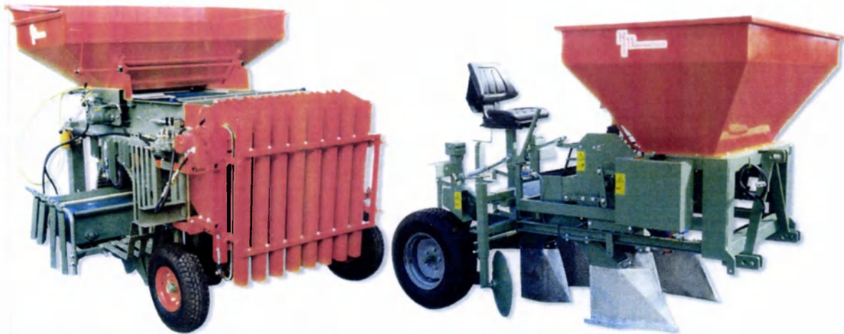
Figuur 4.4. Hyacintentplantzet en een regelplantmachine (Kos mechanisatie)
