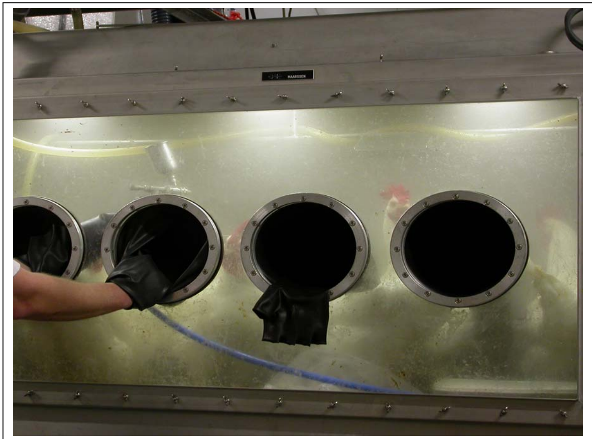
Figuur 5.4 Verneveling van E. faecalis in de isolator. De aërosol die ontstaat, is duidelijk zichtbaar als een 'blauwe' mist.
