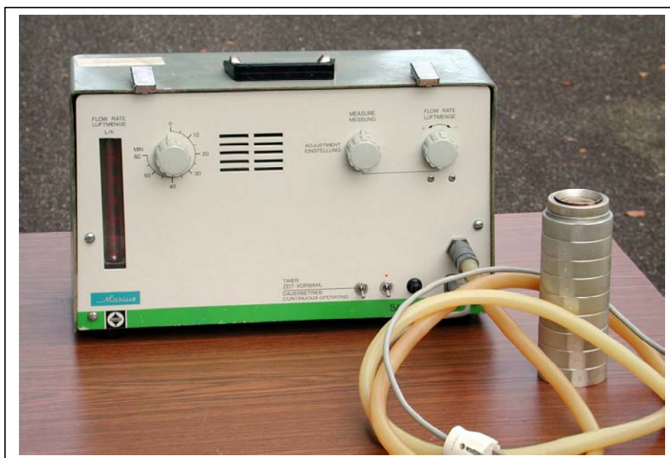
Figuur 5.7 MD2 luchtbemonsteringsapparaat gebruikt voor het controleren van de aërosol efficiëntie.
