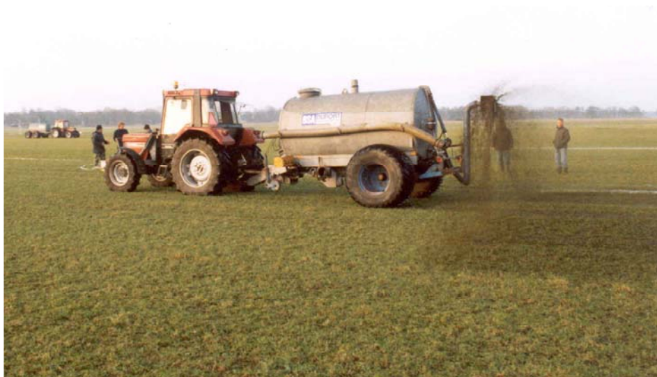
Machine 1 (foto boven) en machine 2 (foto onder) waarmee de mest bovengronds werd toegediend.
