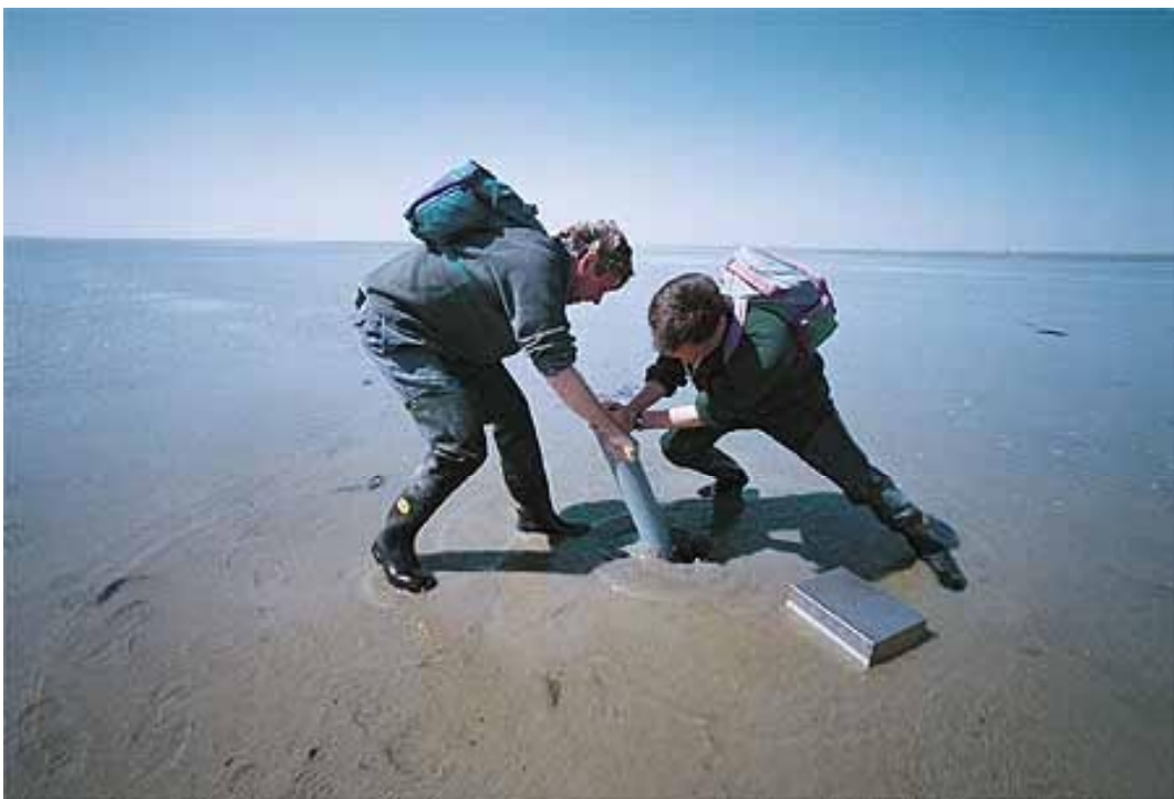
Foto 6. Nemen van een steekbuismonster op het wad. Foto Guy Ackermans.
