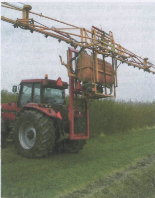
Figuur 7 Landbouwsprayer gemonteerd op een hefboom om hoogopgaande wilg te kunnen sproeien (bron: VOF Oostwaardhoeve).
