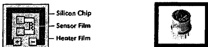
Figuur 3 Weerstandsmeting (semi-conductor)(Detcon).
