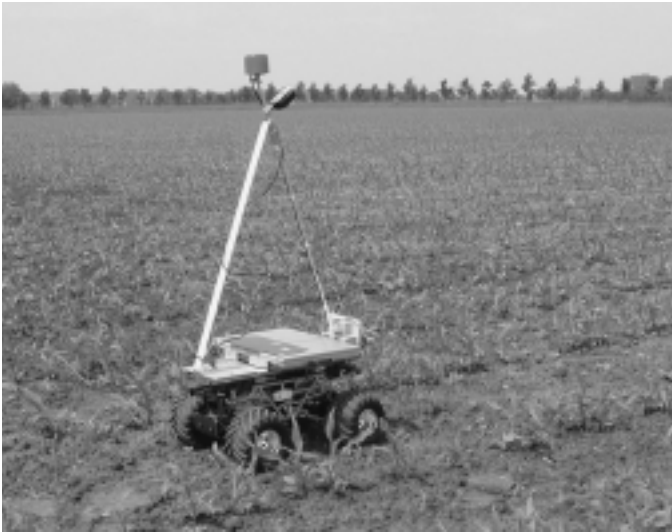
Figuur 3. Sietse: laptop op wieltjes, met een webcam bovenin de mast.
