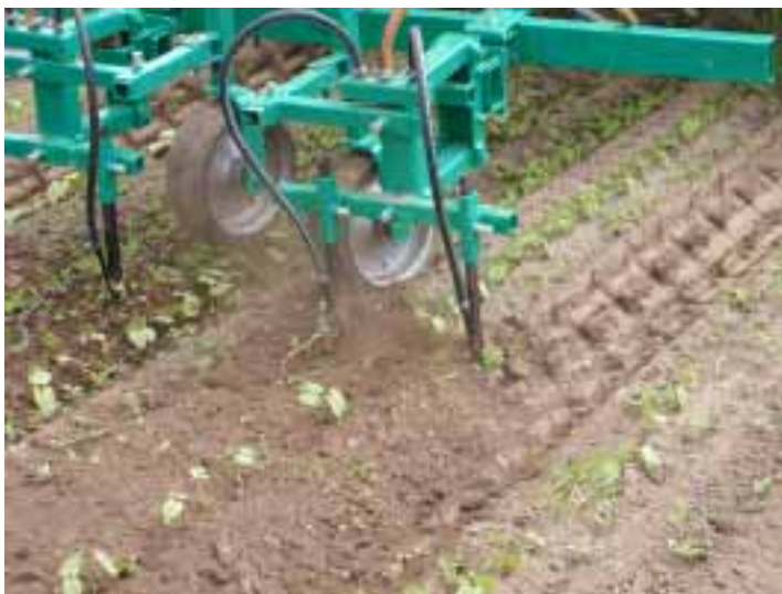
(foto: DLV Adviesgroep, project Onkruidbeheersing in Omschakeling) De Pneumat intra-rijwieder blaast het onkruid uit de gewasrij.
