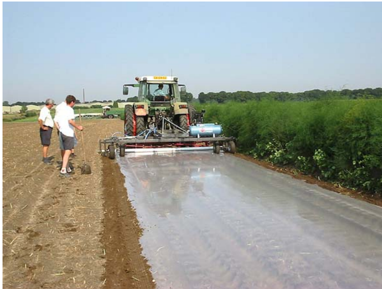
Folielegger die door Abemec Sevenum en PPO is ontwikkeld.
