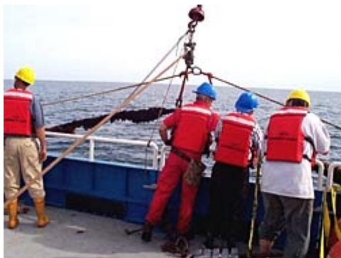
Figuur 2. Inspectie van de longline na 8 1/2 maand op zee. De 3 cm dikke longline is sterk begroeid geraakt met mosselzaad en hydroidpolypen. www.whoj.edu
