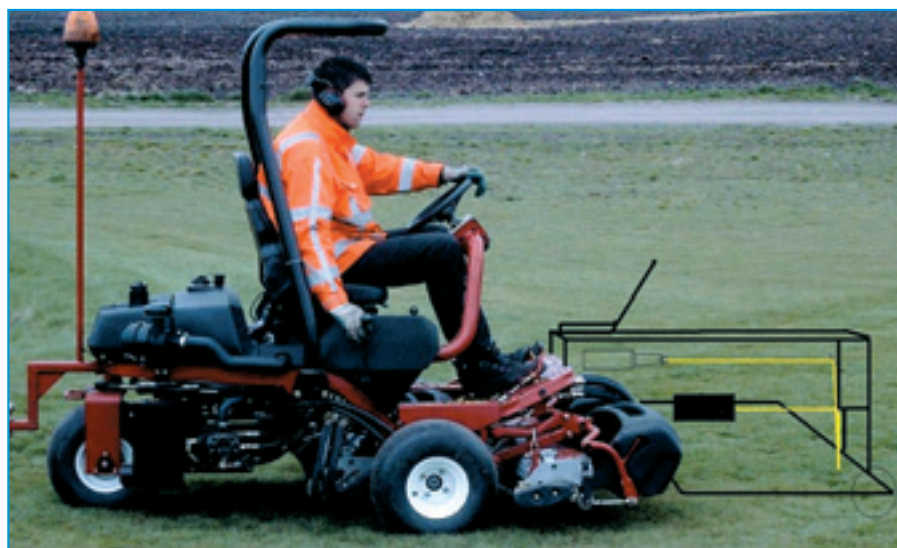
Indicatieve schets van een mogelijk instrument voor golfbanen. In de 'doos' is een sensor en een lichtbron weergegeven, er staat een computer voor verwerking en presentatie bovenop de doos.
