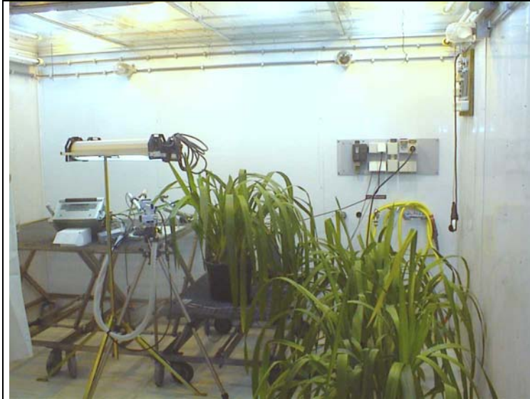
Fig 21 Experimenten in fytotroncellen Opgezet op 21 januari 2004. T = 18C RV =80% daglengte van 10.00 tot 22.00. Temperatuurbehandelingen; 23 en 30 graden. RV instelling 70, 50 en 30 %
