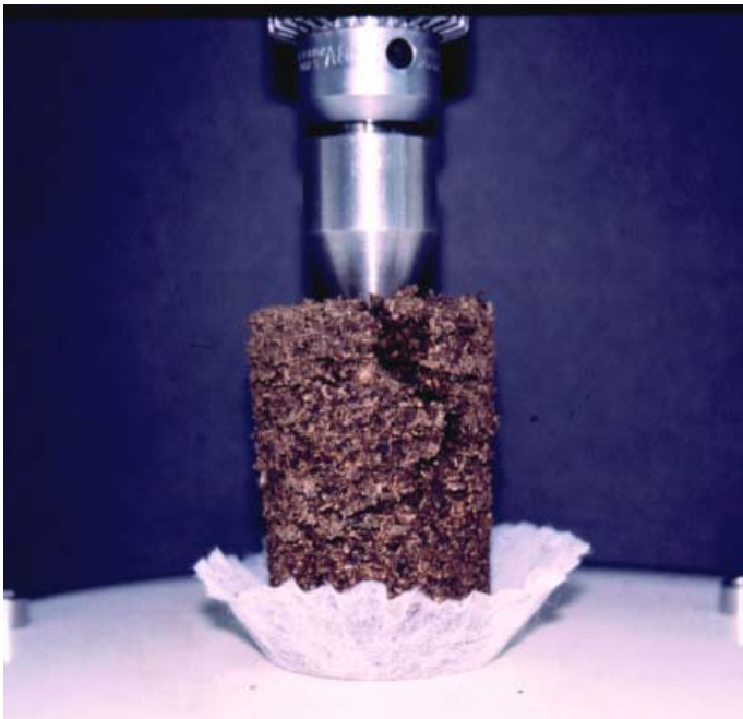
Fig. 1. Cohesiebepaling, een standaard geperst monster wordt met een conus ingedrukt.
