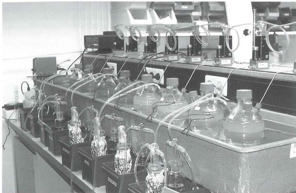
Figuur 2: Experimentele opstelling, met in het midden 2-l mesocosm flessen in een thermogereguleerd bad. Op de voorgrond staan de opvangflessen, bovenaan staan de massa flow control meters.
