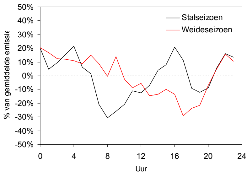
Figuur 4 Dagelijks patroon van de NH 3 -emissie per seizoen, weergegeven als % van de gemiddelde dagemissie.
