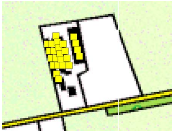
Figuur 4.4 Schematische weergave van de ruimtelijke detaillering (positionering & dimensionering) van een erf, zoals deze in het korte termijn model is ingevoerd, waar de stallen zijn opgedeeld in meerdere, kleinere oppervlaktebronnen te vergelijken met dezelfde bronkarakteristieken als hun grotere equivalent.
