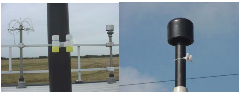
Figuur 5.8 Foto's van twee paar passieve monsternemers bevestigd aan een zwarte aanzuigbuis van een meetstation van het Landelijk Meetnet Luchtkwaliteit van het RIVM (afkomstig uit een ander project!). Hetzelfde type is ook in dit project gebruikt.
