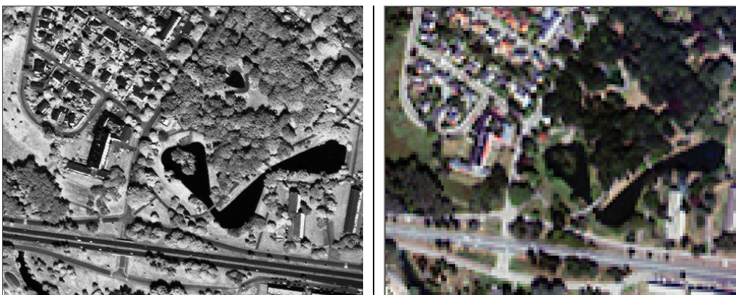
Figuur 3 Voorbeeld van de panchromatische opname (1 m detail) en de multi-spectrale opname (4 m detail)
