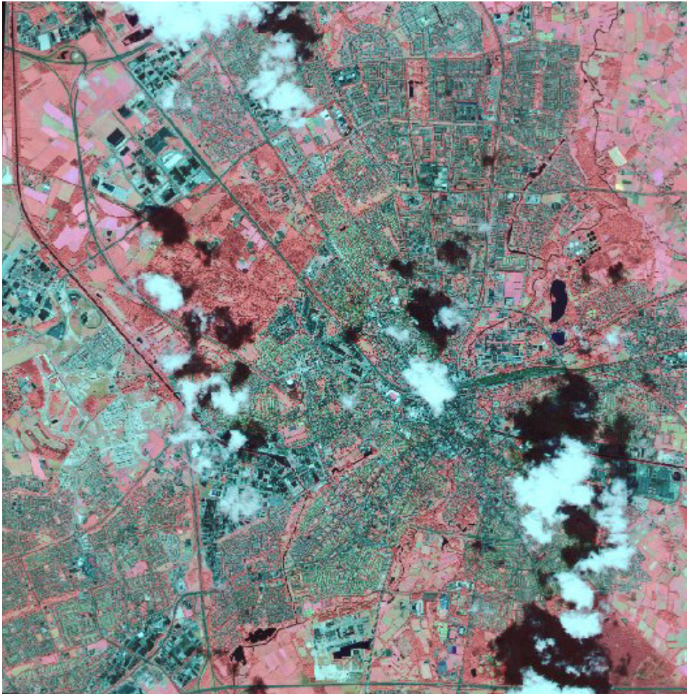
Figuur 2 Ikonos opname van eindboven op 19 juli 2003, afgebeeld als false-color. Rode kleuren in het beeld laten gebieden met vegetatie zien, blauwe kleuren geven verharding, bebouwing en onbegroeide gebieden weer. Verder zijn de wolken (wit) en schaduw (zwart) duidelijk te herkennen. Water wordt op deze opname ook in zwart weergegeven
