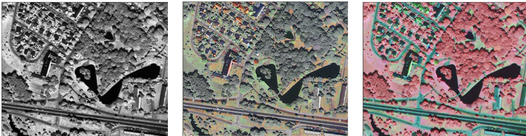
Figuur 4 Voorbeeld van een pan, true-color en een false-color weergave (1 m detail)
