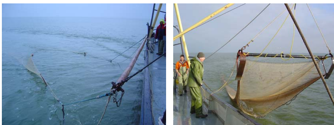
Figuur 3.1.1. Vistuigen in de najaarsbemonstering: grote kuil (links) en elektrokor (rechts)
