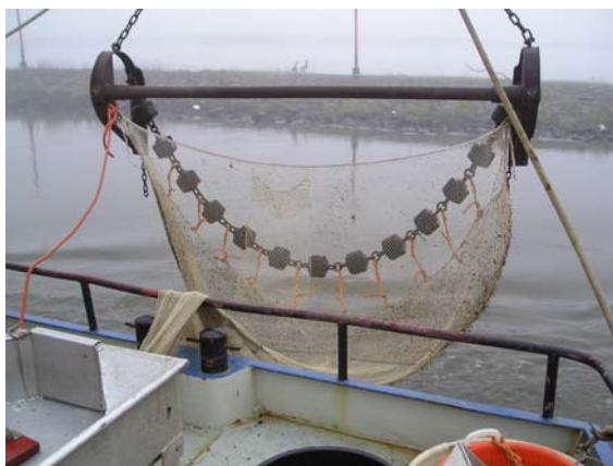
De hoofdstroom en het open water van zijwateren wordt bemonsterd met de boomkor van 3m
