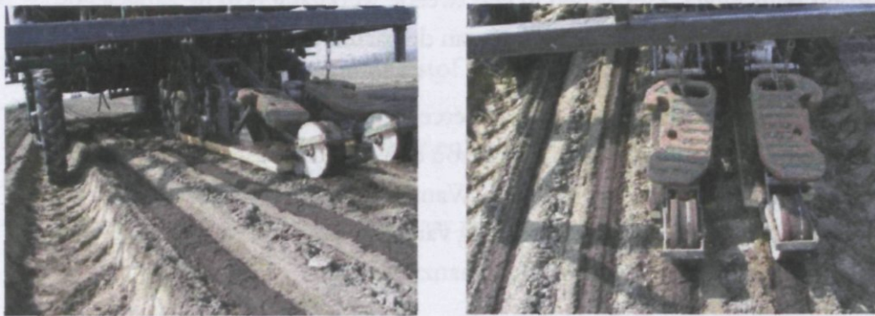
Figuur 2 Zij- en achteraanzicht van de zaaisloffen (8 cm breedte) bij het aanleggen van de proef. In beide figuren is te zien dat een gebolde zaaistrook wordt aangelegd.
