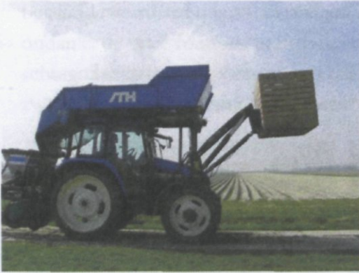
Figuur 4 Het laden van de kuubskisten op het bunkerdak met behulp van de frontlader.
