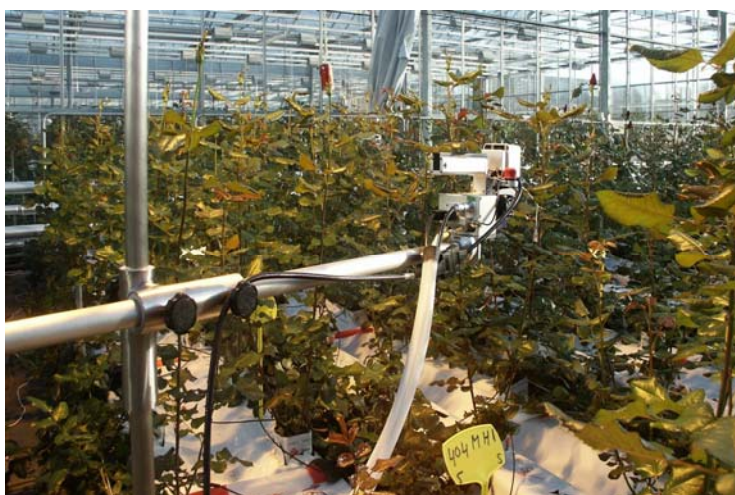
Figuur 2.5 De Licor LI6400 fotosynthesemeter tijdens een meting. Met het nieuwe statief zijn nu ook de bladeren midden op het rolbed goed bereikbaar.
