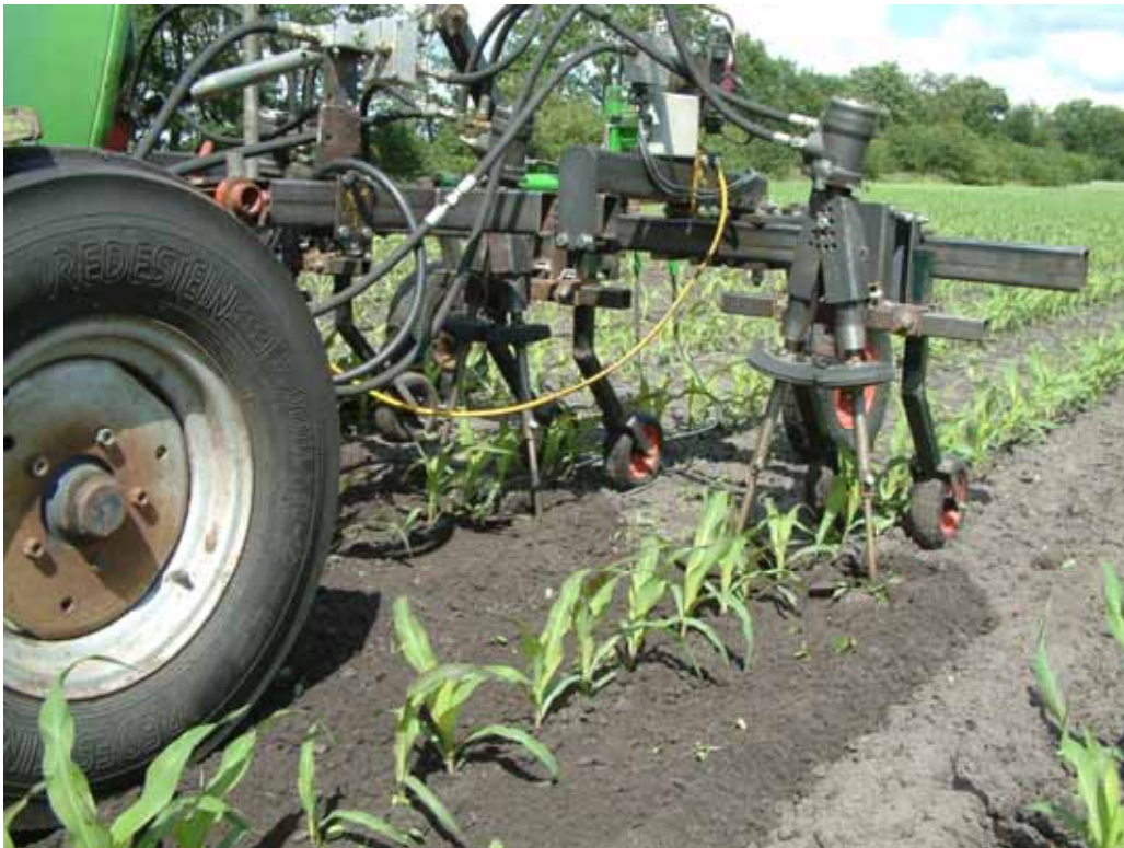
Experimentele roterende schoffel van ASG
