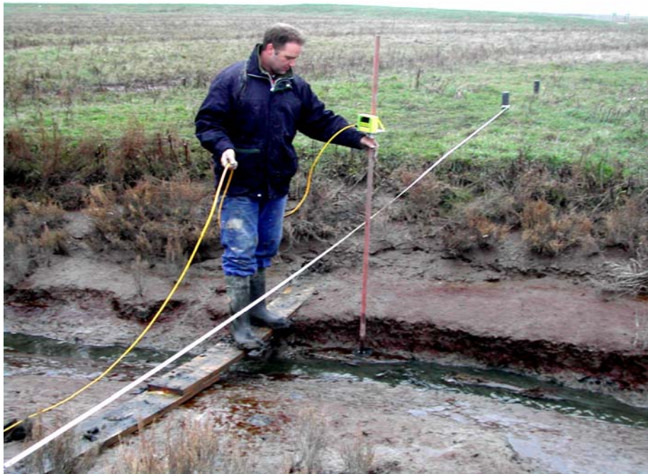
Figuur 2.3 Kreekprofielmeting met behulp van de Compulevel
