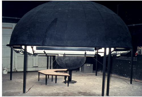
Figuur 3. Meetapparatuur voor het bepalen van de transmissie voor direct en diffuus invallende straling, integrerende Ulbricht-kogel.
