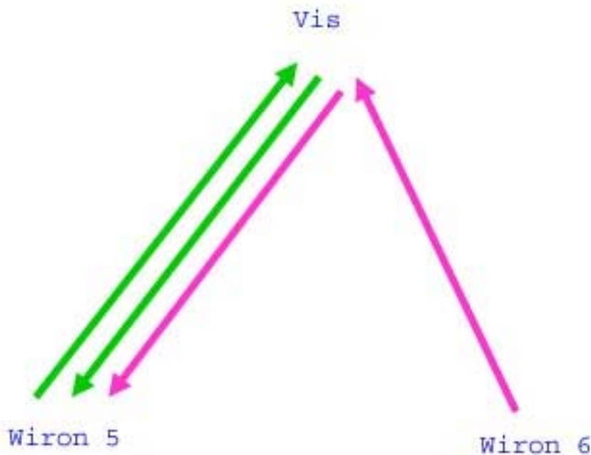
Fig 1 - Principe bistatische sonar, de sonar op de Wiron 5 detecteert zowel de echo's van de pulsen die door de Wiron 5 zelf zijn uitgezonden (in groen weergegeven) als die door de Wiron 6 zijn uitgezonden (paars). Op deze wijze kan de resolutie bij het bepalen van de grootte van een vis aanzienlijk verbeterd worden. Bij een enkele multi frequency sonar kan men vrij nauwkeurig de afstand tot een vis bepalen. Met deze monostatische op-stelling is de richting waarin de vis zich bevindt veel minder goed te bepalen. In fig 2 is dit principe weergegeven.
