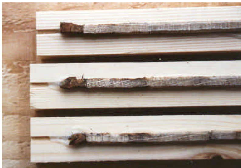
Figuur 3: Boorkernen, hier van eiken, zijn gebruikt om via meting van de jaarringbreedten het effect van bekalking of bemesting op boomgroei en - indirect - op de vitaliteit van het bos te onderzoeken. (Foto: R.Wolf)
