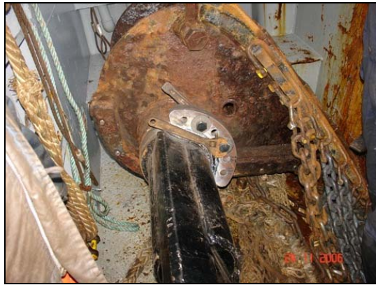
Figuur 10. Stelbouten Flybeam constructie.
