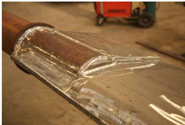
Figuur 11. Aan beide uiteinden van de flybeam zit een ronde buis gelast, voor bevestiging in de vissloffen.
