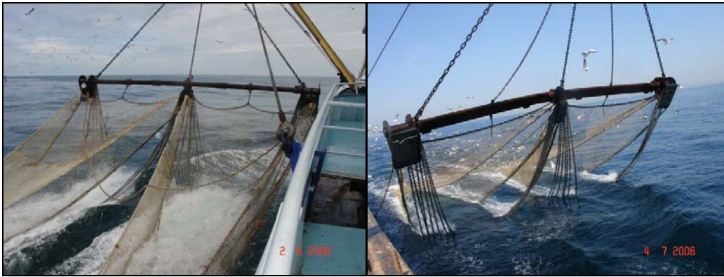
Figuur 12. (Twin-)Flybeam, eerste ontwerp.
