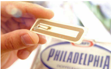
Figuur 7 Het toepassen van RFID tags op voedingsmiddelen die plaats van herkomst, tijdstip van productie en vervoergegevens vastleggen zal steeds meer ingeburgerd raken.
