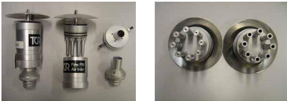
Figuur 2 Monsternamekoppen voor PM10 en PM2.5; links de complete meetset en rechts het verschil in de openingen van de luchtinlaten boven de impactieplaat (grotere openingen voor PM10 monstername)
