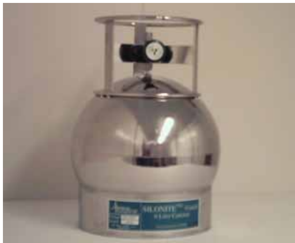
Figuur 1 Roestvrijstalen canister van 6 liter
