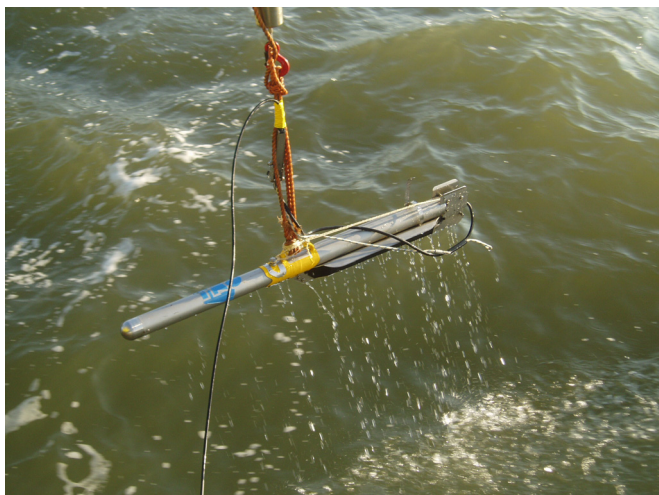
Figuur 3 De side scan sonarvis gebruikt tijdens het onderzoek.
