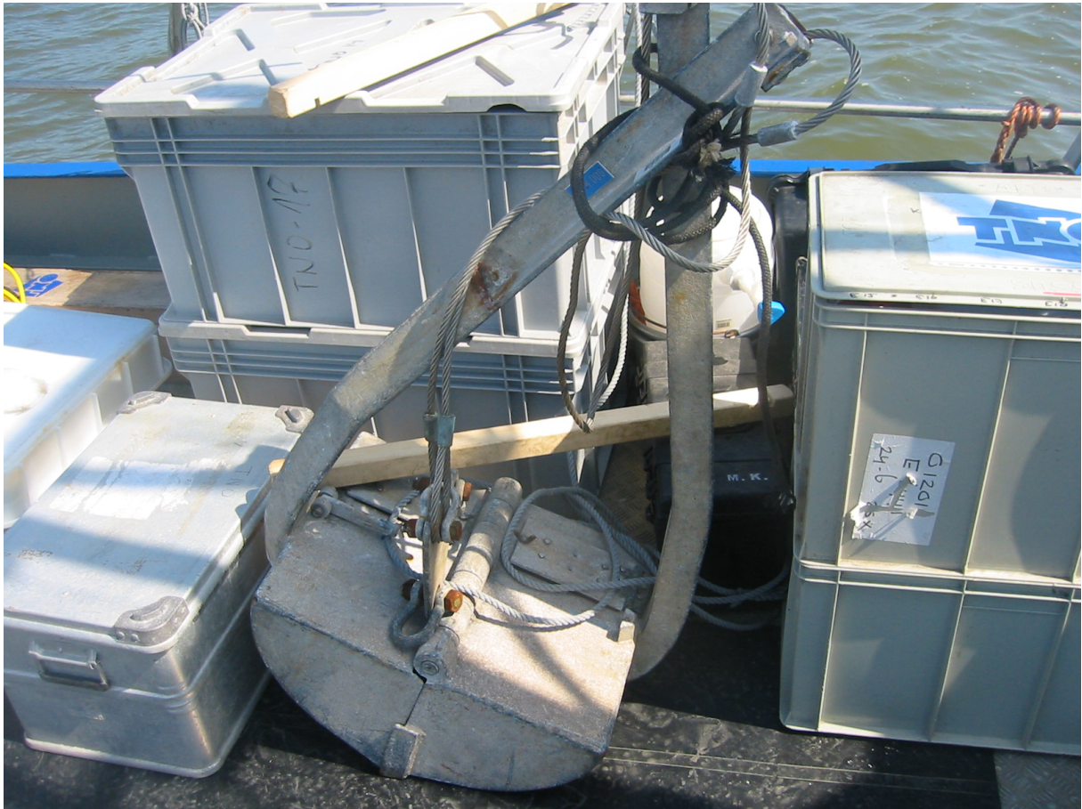
Figuur 5 De gebruikte van Veen happer met een bemonsteringsoppervlak van 0.1 m 2
