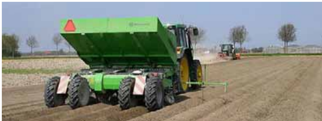
Afbeelding 3.8 Pootafstand variëren op basis van taakkaart mogelijk met Miedema structural
