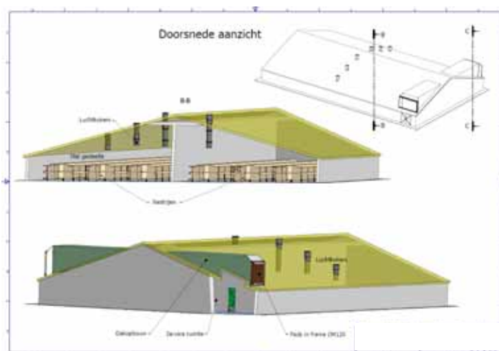
Figuur 3 Tekening van een stal met klimaatconditionering
