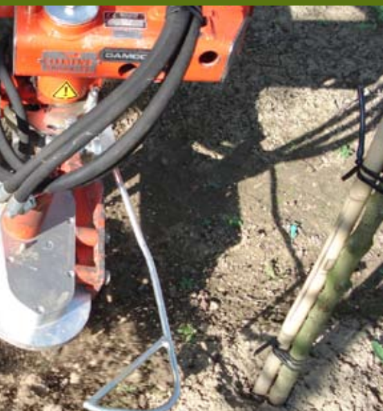
Werpig mes van +/- 30 cm lang en 7 cm breed. Het kan zwenken vlak voor de stam van de boom.
