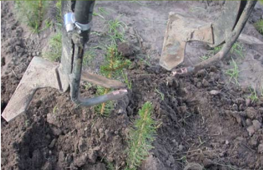
Pneumat: Bij de Pneumat voert een compressor lucht via slangen naar een nozzle die achter aan een schoffel zit. Deze nozzle is zodanig bevestigd dat de samengeperste lucht aan beide zijden van de gewasrij door de gewasrij wordt geblazen. Een optimaal effect wordt verkregen door te variëren met de druk, de rijsnelheid en de afstand tot de gewasrij.
