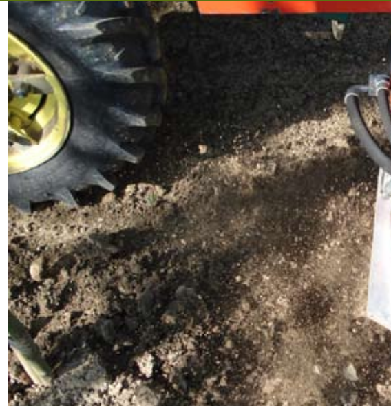
Zwenkschoffel: De onkruidbestrijding op de rij vindt plaats met een langzaam oscillerend mes. Dit mes is bevestigd aan een zwenkmechanisme waardoor het mes terugkeert naar de rij na het passeren.
