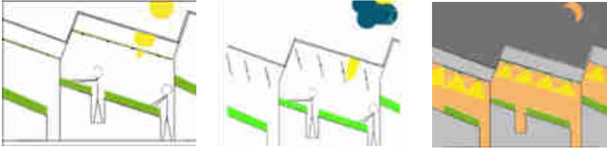
Figuur 15: Regulering van instraling in tuinbouwkas via lamellen bij volle zon, bewolking en 's nachts (belichte teelt).
