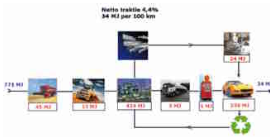
Figuur 3: Crop-to-Craft-analyse voor automobieltransport. Voor 100 km voortstuwing is 34 MJ voortstuwingsenergie nodig, waarvoor in de fossiele keten 428 MJ olie uit een bron moet worden gehaald (8% rendement). In de biomassaketten moet 771 MJ biomassa aangemaakt worden voor eenzelfde prestatie (4% rendement).
