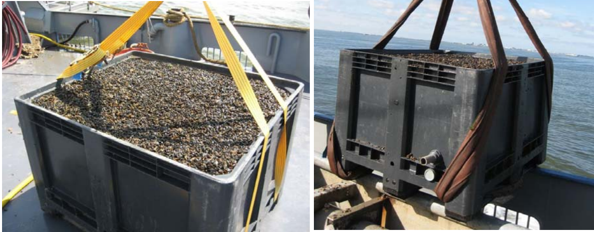
Figuur 2. Weegmethode oogst per m 3 . Een 550 liter kist is tot de rand gevuld met mosselzaad en gewogen met een hangweger.
