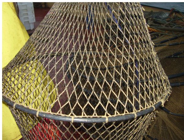
Figuur 2.2 Grote mazen in de laatste kub van de schietfuik.
