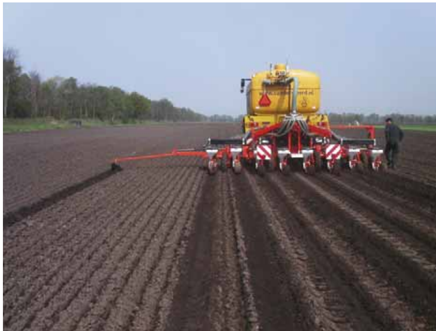
In maïs is het mogelijk 30 procent te besparen op de stikstofgift door dierlijke of kunstmest in de rij toe te passen. Vanwege de noodzakelijke nauwkeurigheid en de afname van het areaal dat dagelijks gezaaid kan worden wordt deze techniek voor dierlijke mest nog nauwelijks in de praktijk gebruikt.
