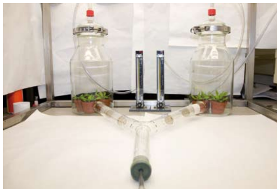
figuur 1 In een Y-buis kun je de voorkeur van een sluipwesp meten Bron: Hans Smid
