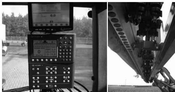
Figuur 4. Instellingen- en informatieschermen van SensiSpray (links) en Vario-Select pneumatische dophouders (rechts) met vier verschillende spuitdoppen per dophouder die individueel geschakeld kunnen worden.
