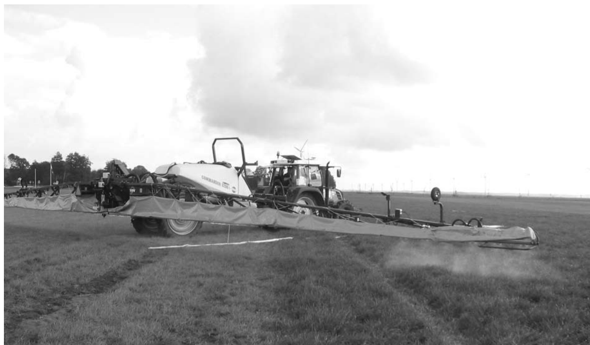
Figuur 5. Afgiftetest SensiSpray op gewasbanen met grote verschillen in biomassa. De sectie aan rechterkant van de spuitboom geeft meer middelafgifte op dicht gewas.
