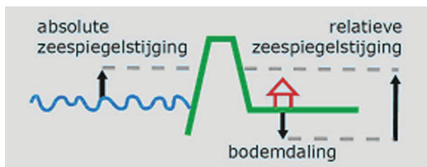
Figuur 2.14 Schematische weergave van het verschil tussen absolute en relatieve zeespiegelstijging als gevolg van bodemdaling
