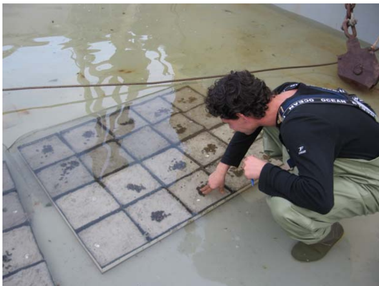
Figuur 28. Tableau van beton onderverdeeld in met gaas bedekte en onbedekte vakken met mosselen in het ruim van de YE 198.
