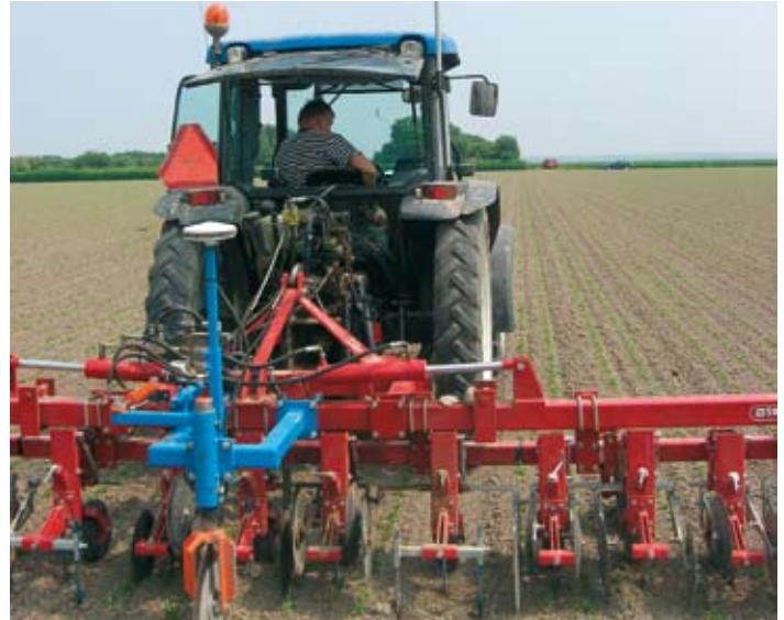
Als met GPS planten en schoffelen goed op elkaar zijn afgestemd zijn met bredere schoffels en vingerwieders de plantrijen schoon te houden.
