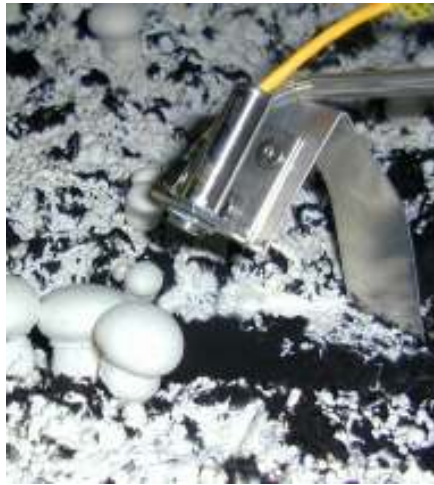
Infrarood sensor smalle werking met richtbundel voor het meten van individuele knop/hoed temperatuur
