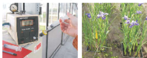
Een luchtmonster van onder het plastic bevat 1,6% zuurstof (links). Na de behandeling zijn irissen geplant als toetsgewas (rechts).
