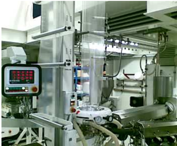
Figuur 4 Filmblaasexperiment op de installatie van AEP.
