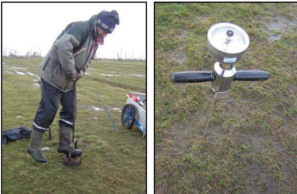
Figuur 2. Een illustratie van de grondboor gebruikt voor het bemonsteren van de beschikbare prooidieren (linker foto) en de penetrometer gebruikt voor het bepalen van de indringingsweerstand van de bodem (rechter foto). Foto's: Frans Möller.
