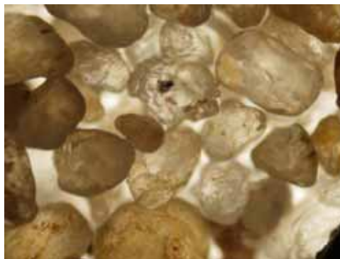
Grof zand: metselzand 0-2mm Noordzee (40x vergroot microscoop) (Huizenga, 2006)
