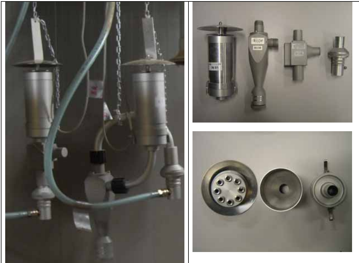
Figuur 2 Meetopstelling voor PM10 en PM2.5 stof concentratiemeting. Links: Meetopstelling op locatie. Rechtsboven: inlaat, de PM10 en PM2.5 cyclonen en de filterhouder (van links naar rechts). Rechtsonder: constructie van de inlaat
