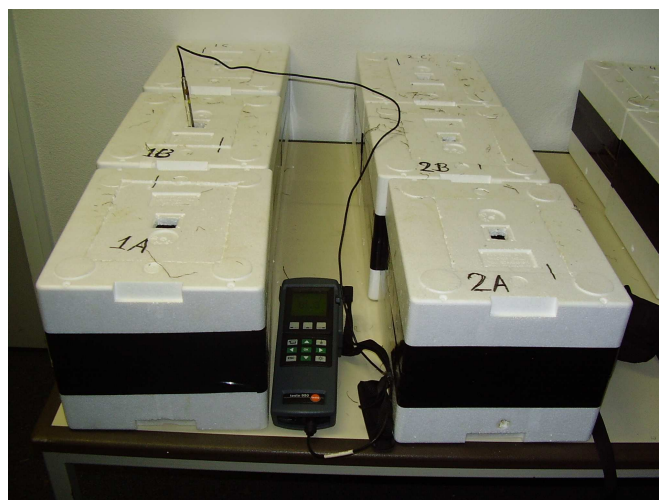
Foto 1 Polystyreen boxen en digitale thermometer voor meten van broeigevoeligheid
