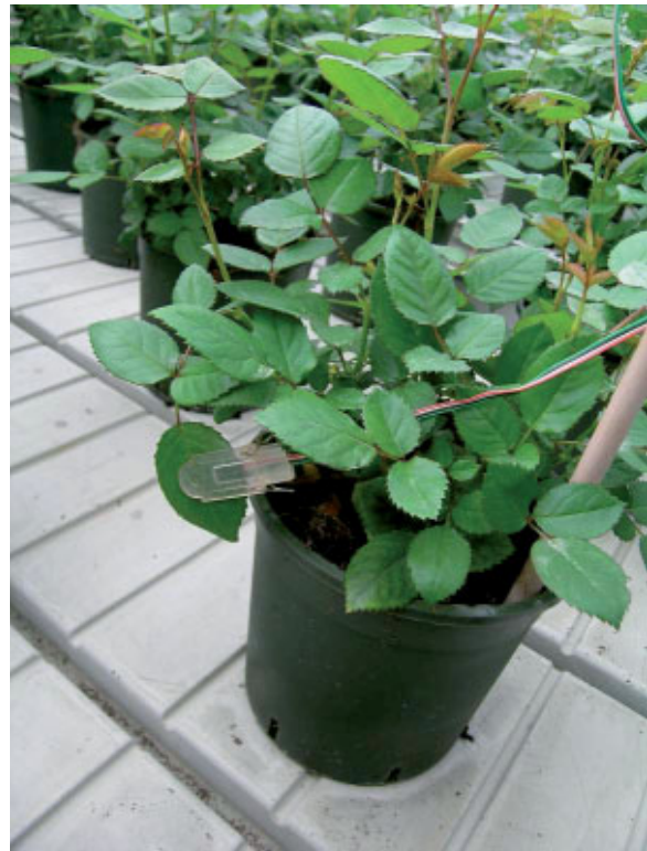
Figuur 6. Bladdiktemeter op een rozenblad.
